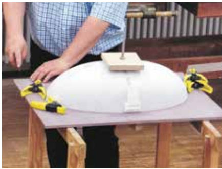
Das Spülbecken aus Staron wurde in eine Mineralwerkstoffplatte eingepasst.
