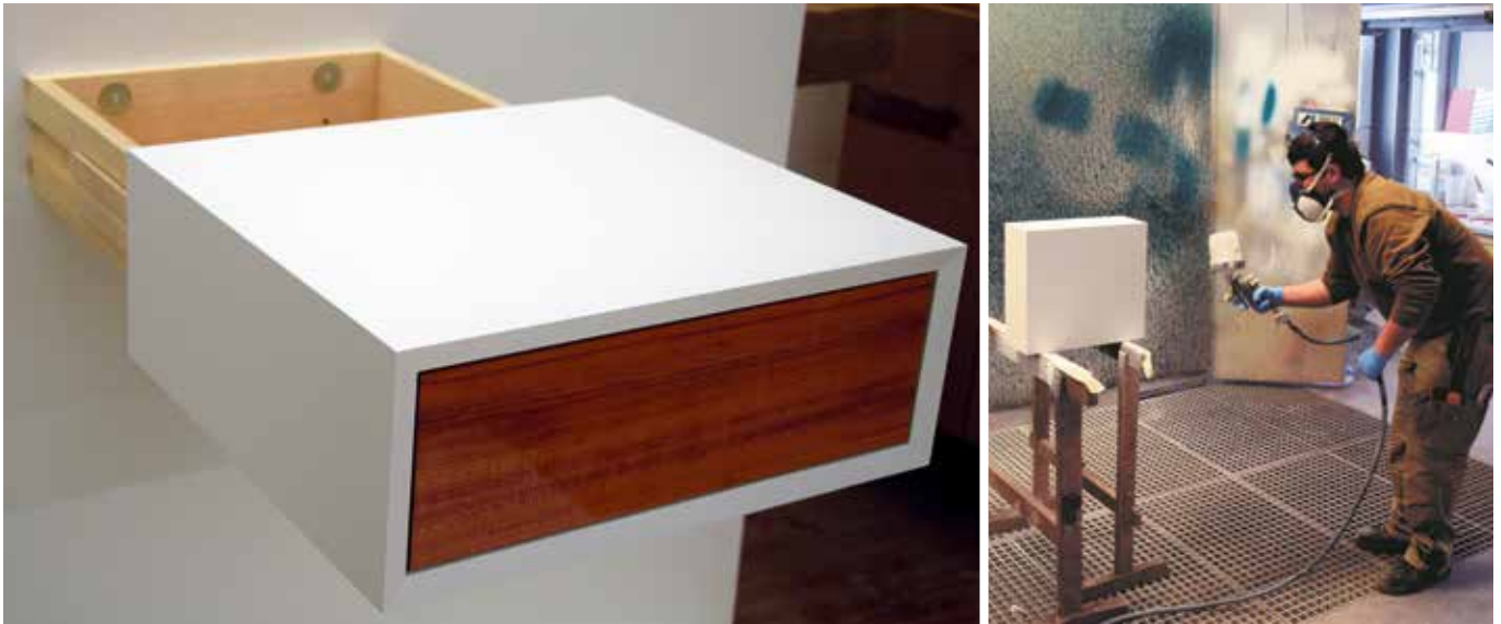
Der vollendete Nachttisch von Giacomo Micheli (Bild links). Bei seinem Entwurf wird der äußere Korpus über den an die Wand montierten Schubkasten nach vorne hinweggezogen. Gezinkter Schubkasten und Schubkastenführung sind in Esche massiv gefertigt. Der Korpus ist aus weiß lackiertem MDF. Die vordere Blende im Korpus ist aus hochglanzlackierter Pflaume. Daneben sehen wir Giacomo Micheli im Lackraum der Lehrwerkstatt, wie er den Korpus seines wandhängenden Nachttisches lackiert.
