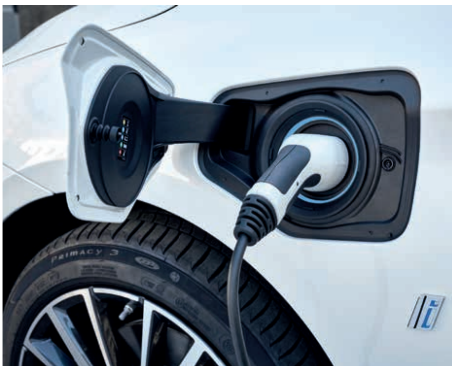
Ladezeiten: Für eine komplette Ladung benötigt der BMW Active Tourer 225xe 2,2 Stunden (16 A, 230 V). Es können aber auch 3,25 Stunden sein (10 A, 230 V).
